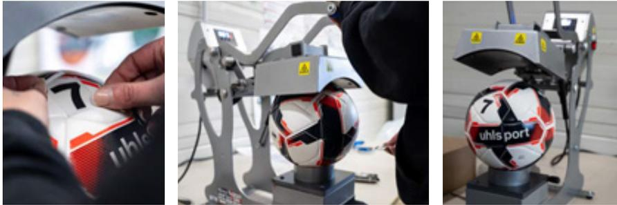
Das Logo wird mittels industriellem DTF Druck direkt auf die Balloberfläche gedruckt.
